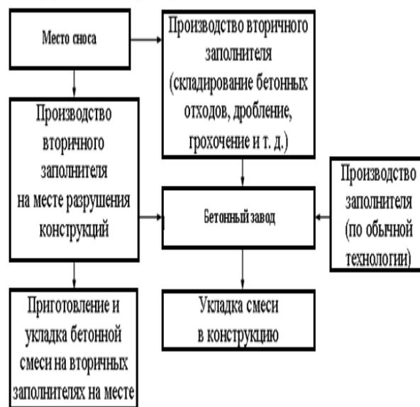
**Рисунок 2.** Принципиальная схема производства вторичного заполнителя и бетона на его основе
