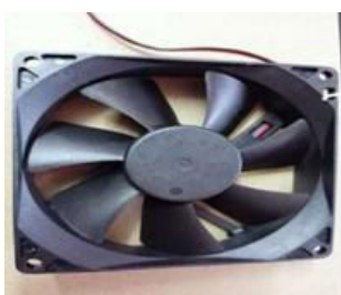
Fig 7: 12 Volt DC exhaust fan
