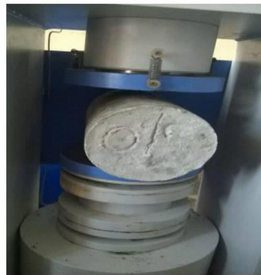
PLIT TUBE TENSILE TEST APPARATUS
