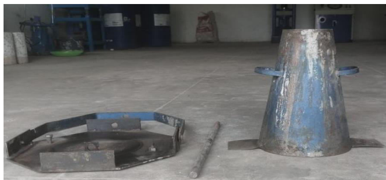
Fig. 5.2: Slump cone apparatus
