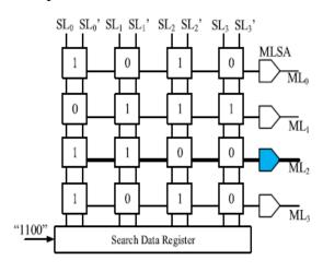
Fig. 3. 4×4 CAM array
