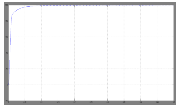
Fig. 11 DC-link voltage of AVSI
